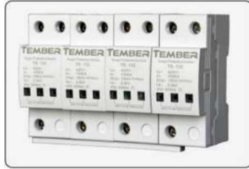
应用：产品主要用于通信、铁路、计算机网络、电力、气象、交通、住宅等领域交流电源设备的第一级（B级）雷电过电压以及操作过电压的防护，安装在低压主（分）配电柜或低压总开关柜内，并联在电源进线处。
