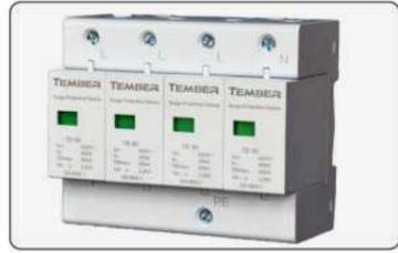
应用：产品主要用于通信、铁路、计算机网络、电力、气象、交通、住宅等领域交流电源设备的第二级（C级）雷电过电压以及操作过电压的防护，安装在楼层或入室低压配电箱、低压分电柜内，并联在电源进线处。
